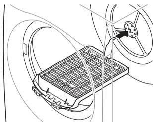
**3** Collocare il cestello per asciugatura sulla struttura al di sopra del filtro
