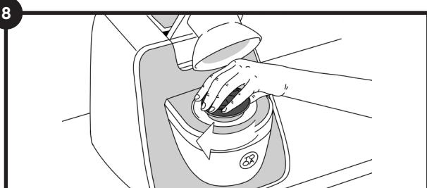
Si la consistance de votre gelato n'est pas à votre goût, insérez à nouveau le couvercle et les pales en les faisant tourner légèrement. Placez à nouveau le verre dans le compartiment et baissez le bras-moteur. Pour éviter un cycle de refroidissement supplémentaire, le bouton de démarrage doit être activé dans les 60 secondes suivant la fin du premier cycle.
